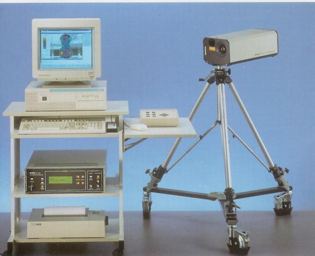
Abgebildet ist das komplette Polytec-Scanning-Vibrometer mit Vibrometer-Controller, Scanning-Kopf, 50 MHz-PC und Steuereinheit.
